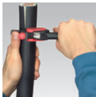
Obrócenie narzędzia do cięcia po obwodzie
