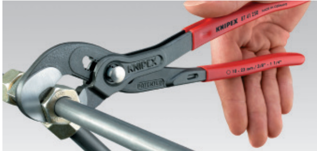
Szczypce wielofunkcyjne używane jako drugi klucz podczas dokręcania nakrętek zabezpieczających
