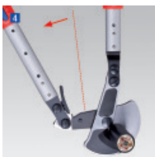
Po wykonaniu pierwszego cięcia otworzyć ramiona za pomocą mechanizmu zapadkowego
