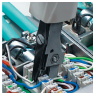
Wciskanie i odcinanie przewodu w jednej operacji
