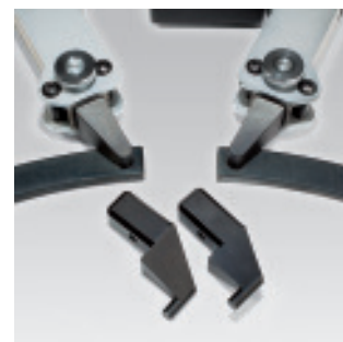
Wymienne końcówki do montażu pierścieni wewnętrznych i zewnętrznych
