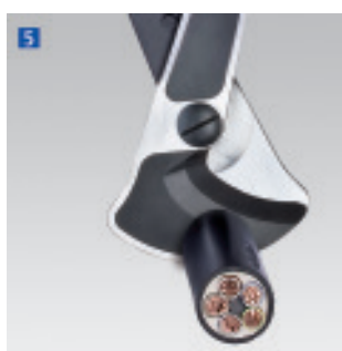
Powtórz czynność cięcia i przestawiania ramion do momentu przecięcia kabla
